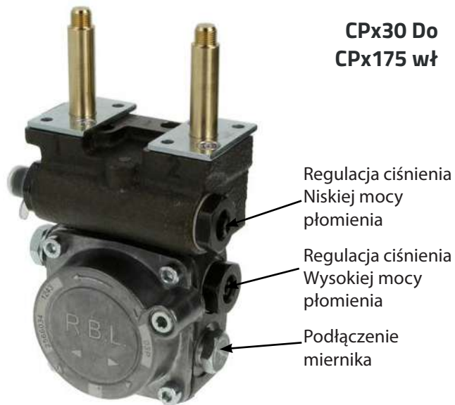
Regulacja ciśnienia palnika
